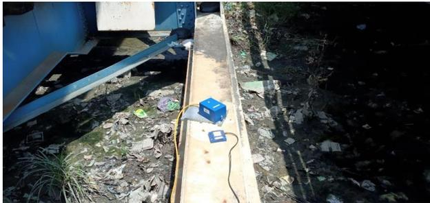
Gambar 7. Peletakkan sensor pada gelagar jembatan
